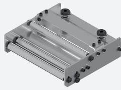
独自のカムフォロワにより材料の踊りを防止し安定して金型へ送ります。前方の二本のローラーは50度の無段傾角度調整が可能で材料の厚さによって平行ガイドから傾斜ガイドへ自由な形に使い分ける事が出来ます。上部の平板は材料切れセンサー等の取付板として使用できます。
