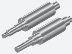
S45Cの高周波焼き入れと1000分次のミクロン研磨仕上げにより高精度・高耐久で長期稼働でも材料を送り続けます。
